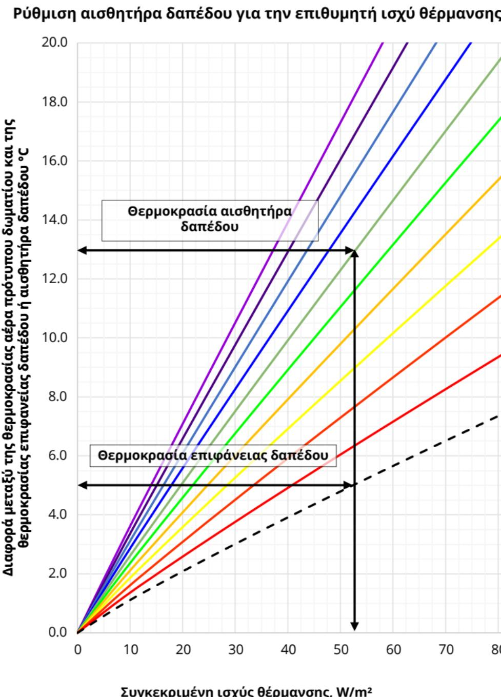
Χρησιμοποιώντας το παραπάνω γράφημα μπορεί κανείς να βρει τη συγκεκριμένη ισχύ θέρμανσης ενός συστήματος ηλεκτρικής ενδοδαπέδιας θέρμανσης βάσει της διαφοράς ανάμεσα στην πρότυπη θερμοκρασία αέρα δωματίου και αυτή της επιφάνειας ή του αισθητήρα δαπέδου για τις διάφορες επενδύσεις δαπέδων.
