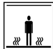
Οι μονάδες θέρμανσης με εύκαμπτα φύλλα τοποθετούνται στο δάπτεδο. MHN διεισδύετε με καρφιά, βίδες ή παρόμοιες συσκευές. MHN περιορίζετε τη θερμική εκπομπή του θερμαινόμενου δαπέδου MHN τοποθετείτε υλικά άλλα από αυτά που συνιστώνται
