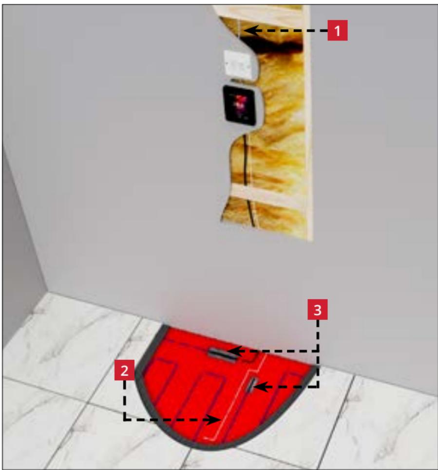
**1** Η παροχή στο θερμοστάτη ΠΡΕΠΕΙ ανά πάσα να προστατεύεται από διακόπτη διαρροής εντάσεως (RCD) ή διακόπτη διαρροής με ασφάλεια (RCBO) 30mA. RCD και RCBO με χρονική καθυστέρηση δεν πρέπει να χρησιμοποιούνται. Δεν πρέπει να συνδέεται θέρμανση άνω των 7,5 kW σε κάθε RCD ή RCBO 30mA. Για μεγαλύτερα φορτία, χρησιμοποιήστε πολλαπλά RCD ή RCBO.
