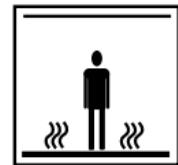
Ηλεκτρική καλωδίωση και πάνελ θέρμανσης εντός του δαπέδου. MHN διεισδύετε με καρφιά, βίδες ή παρόμοιες συσκευές. MHN περιορίζετε τη θερμική εκπομπή του θερμαλόνυμενου δαπέδου.
